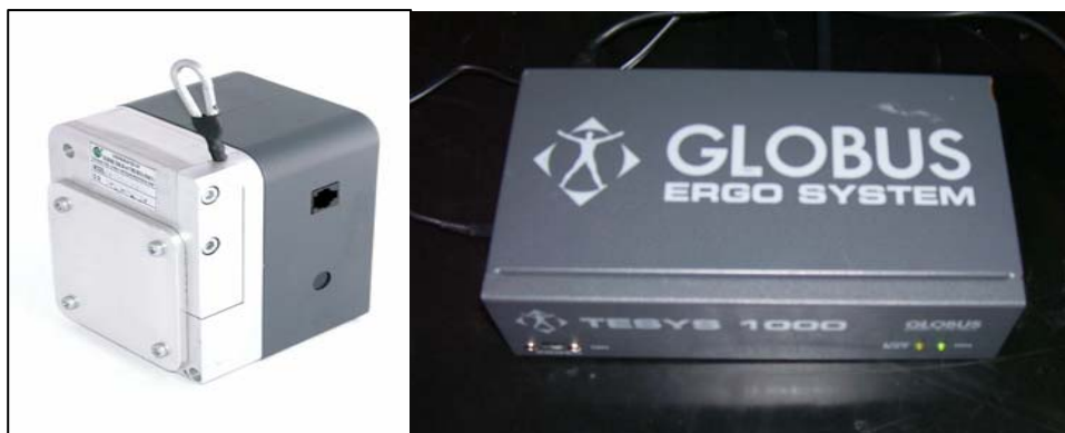
Figura 1 – Equipamento Globus Ergo System - Módulo de Avaliação Dinâmica: Real Power. A) Encoder dinâmico; B) TESYS 1000.
